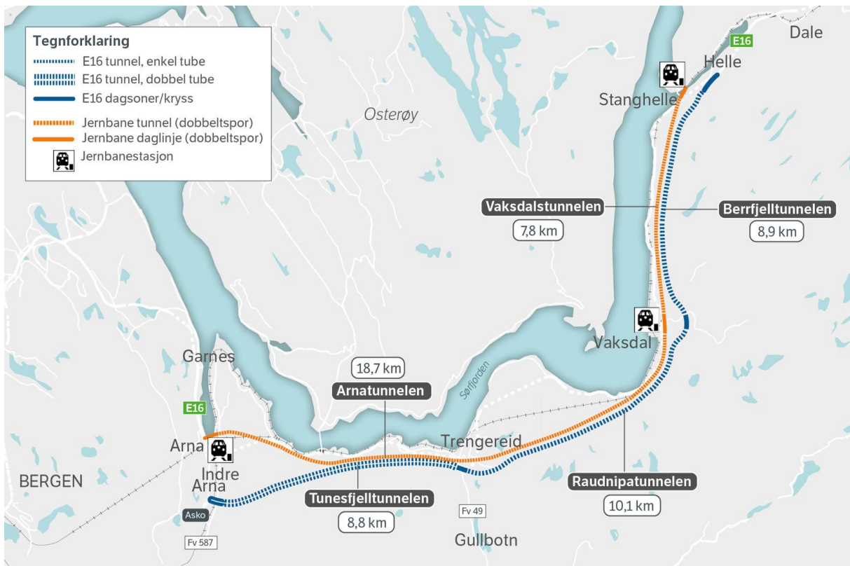
Figur 2-1. Ny jernbane- og vegtrase mellom Arna og Stanghelle som er vedtatt i reguleringsplan. Illustrasjon: SVV.
