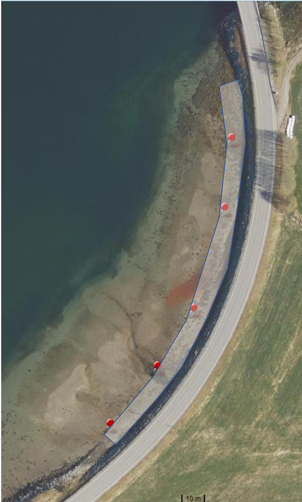
Figur 4 Flyfoto viser område for utfylling (grått område) angitt i figur 3. De røde pinnene/merkene angir utbredelsen av utfyllingen ca. 10 m ut fra eksisterende fylling langs E39.
