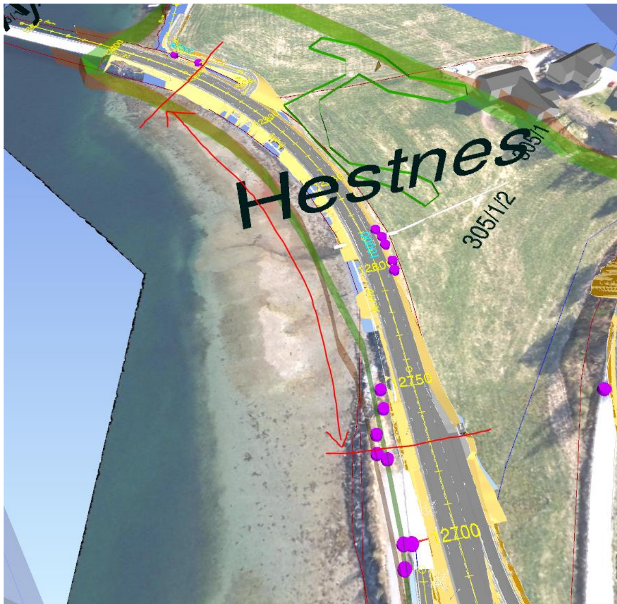
Figur 3 Modellutsnittet viser linje for ny E39. Utfylling i sjø er aktuelt i et ca. 10 m bredt belte mellom profil 12730 og profil 12950 angitt på kartet mellom de to røde strekene. Flyfoto i figur 4 angir merker satt ca. 10 m ut fra eksisterende fylling.
