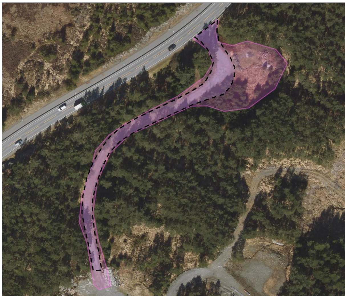
Figur 5-4 Tiltaksområde for utbedring av tilkomstvei og innkjørsel. Stiplet svart linje er veiens avgrensning mens lilla markering viser omtrentlig avgrensning for hvor det er tilførte masser i forbindelse med selve tilkomstveien. Fase 1A er området sør for tilkomstveien.
