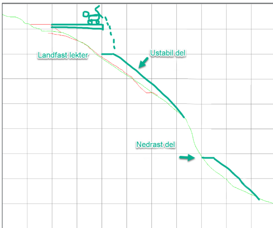
Figur 2-5: Skjematisert snitt av hvordan prosessen ved dypvannsdeponiet vil se ut. Trailere vil kjøre ut på strandkantdeponiet, for å så tippe ut sprengsteinsmasser. Disse vil legge seg langs bergveggen (ustabil del), og en del vil falle helt ned mot bunnen av bergveggen (nedrast del).
