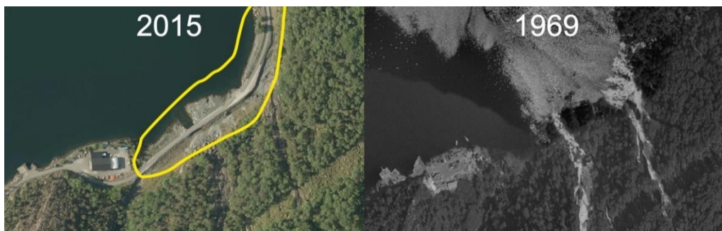
Figur 10-1: Viser Ortofoto av Åskåra. T.v.: ortofoto fra 2015. Gult område i bildet fra 2015 viser utfyllinger i strandsonen ifm. vei. T.h.: ortofoto fra 1969. Den gang fantes det ikke en vei i dette området, men man kan tydelig se vannutløpene her.
