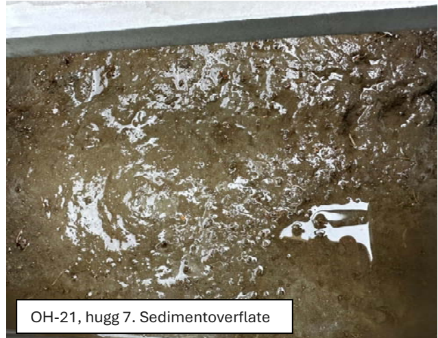
Figur 3-52 Bilder fra bløtbunnsprøvetaking på stasjon OH-21, hugg 4 (kompakt sediment, mot leire) og hugg 7 (overflate sediment, brunt organisk topplag) 10. april 2024.
