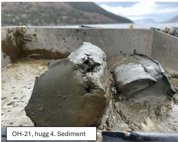
Figur 3-52 Bilder fra bløtbunnsprøvetaking på stasjon OH-21, hugg 4 (kompakt sediment, mot leire) og hugg 7 (overflate sediment, brunt organisk topplag) 10. april 2024.
