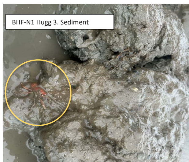
Figur 4-28 Bilder av bløtbunnsprøvetaking på stasjonen BHF-N1. Øverst tv: Sediment fra hugg1. Finkornet grått sediment, med brunere organisk topplag. Øverst th: Skytt bunndyrprøve, hugg 1, rest i 1mm rist. Viser at sedimentet inneholder en stor andel stein/grus. Nederst tv: Sediment fra hugg3. Finkornet grått sediment, med brunere organisk topplag. Krepssdyret trollhummer innringet. Nederst th: Siktet bunndyrprøve fra hugg 4.
