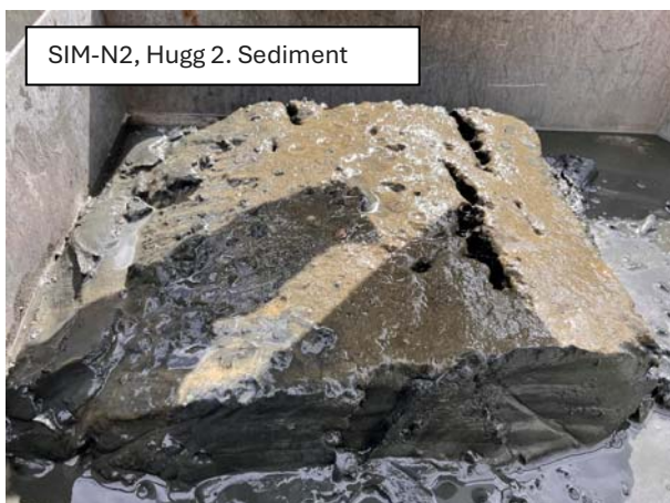
Figur -4-2 Bilder fra bløtbunnsprøvetaking på stasjonene SIM-A1, SIM-A2 og SIM-N2 i Simadalsfjorden, 25. april 2024. Til venstre: Mørkt grått sediment med tydelig brunt organisk sedimentert topplag i grabb. Til høyre: Siktet bunndyrspørve.
