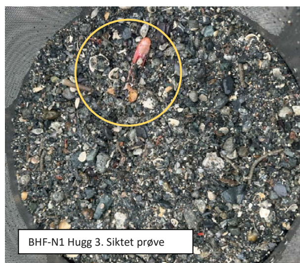
Figur 4-28 Bilder av bløtbunnsprøvetaking på stasjonen BHF-N1. Øverst tv: Sediment fra hugg1. Finkornet grått sediment, med brunere organisk topplag. Øverst th: Skytt bunndyrprøve, hugg 1, rest i 1mm rist. Viser at sedimentet inneholder en stor andel stein/grus. Nederst tv: Sediment fra hugg3. Finkornet grått sediment, med brunere organisk topplag. Krepssdyret trollhummer innringet. Nederst th: Siktet bunndyrprøve fra hugg 4.
