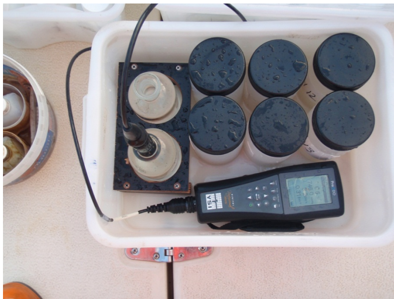
Figur 5: YSI pro.ODO som ble benyttet for direktemålinger av oksygen i felt.
