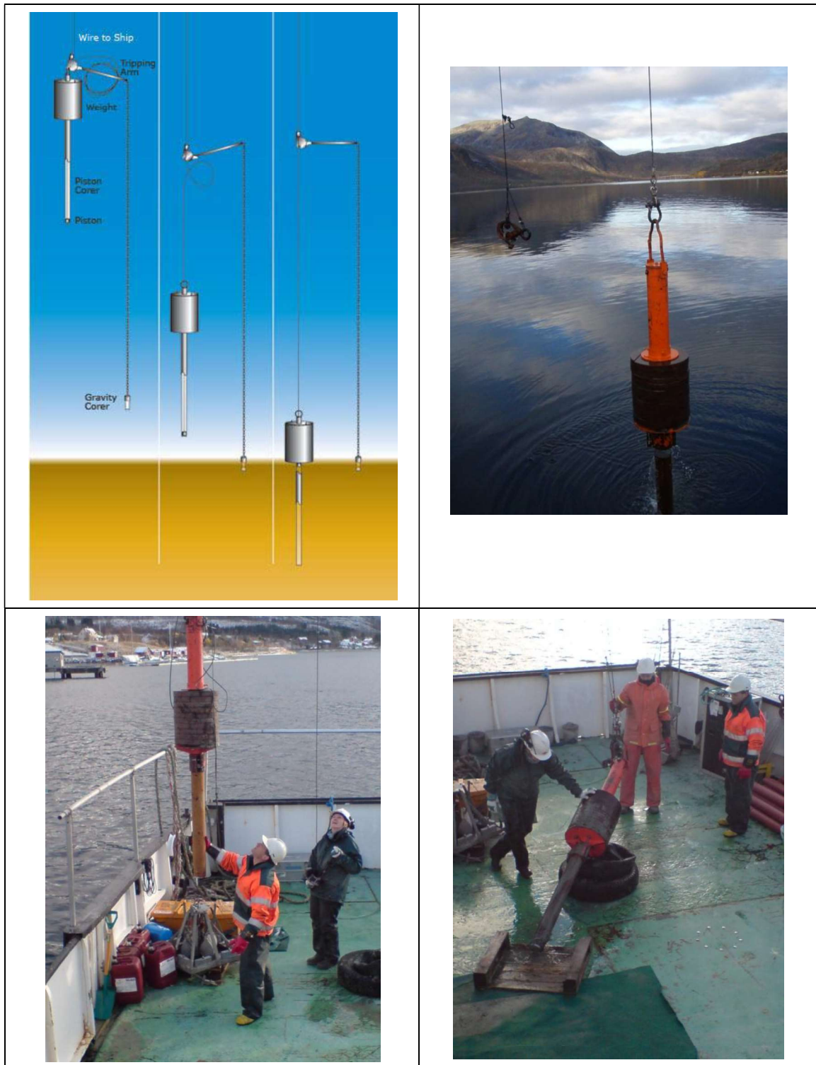
Figur 2 Prinsippskisse for prøvetaking med "pistoncorer". Multiconsults "pistoncorer" i bruk.
