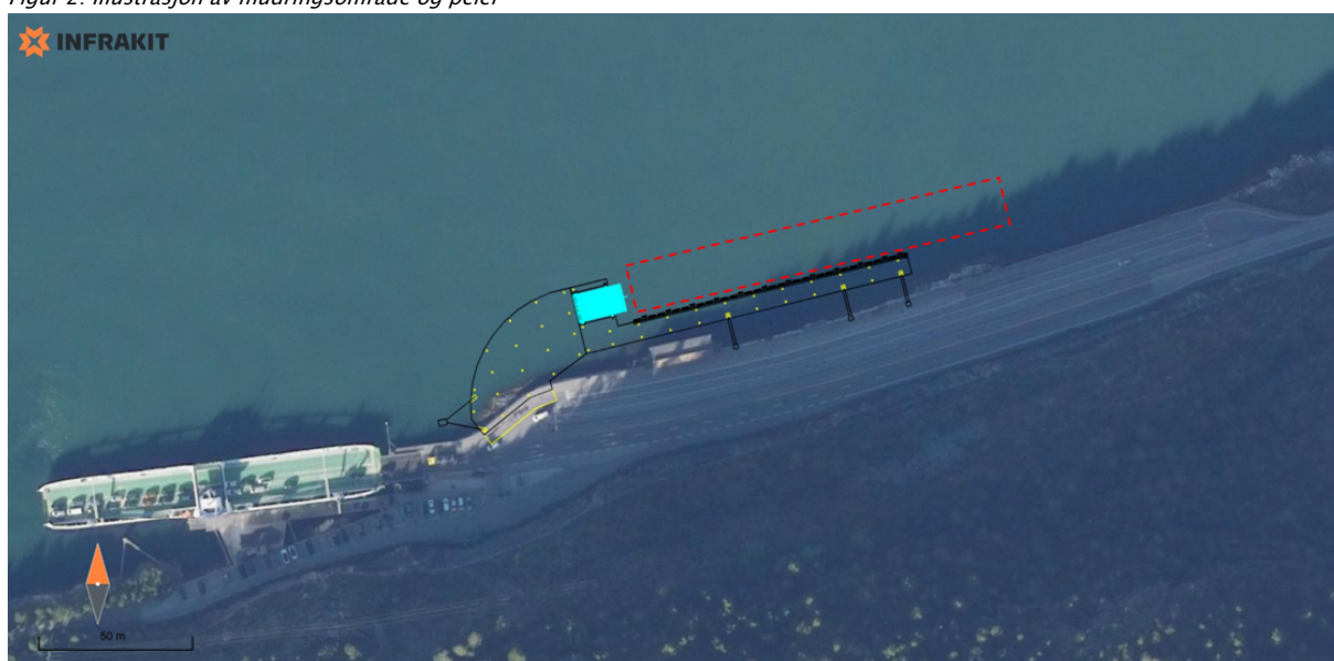
Figur 3: illustrasjon av plassering av stålrørspeler og mudringsområde
