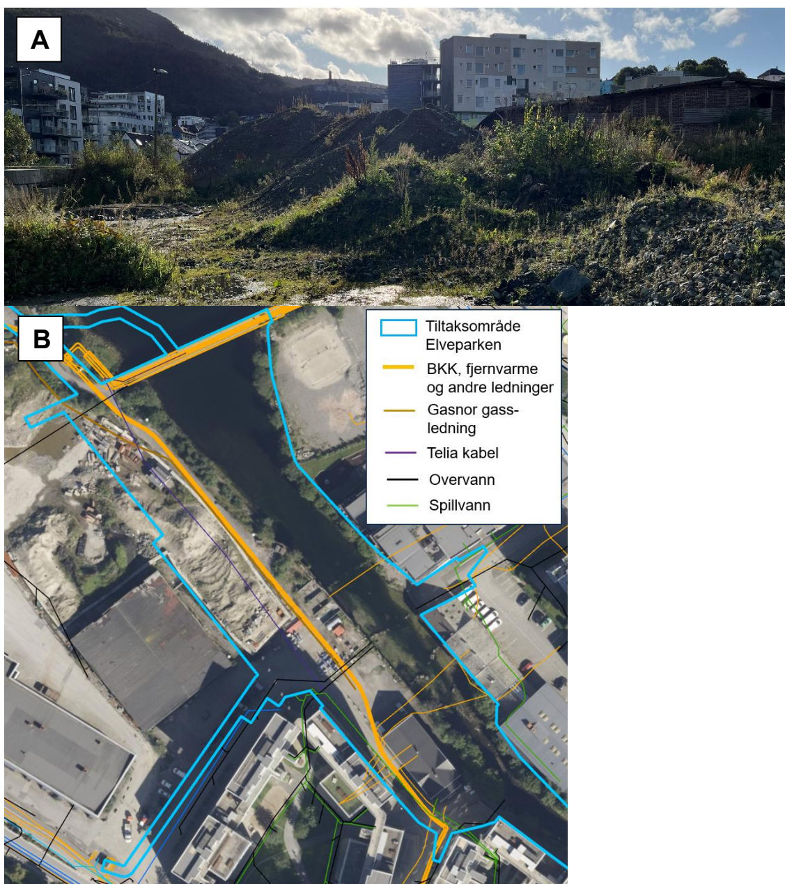
Figur 59 Bilde og kart over vestbredden langs den nedre delen av elven der tilkomst til arealene for prøvetaking har vært utfordrende pga. A) et masselager som i dag dekker deler av Elveparkens arealer, og B) mange ledninger i bakken med tilhørende hensynssoner.
