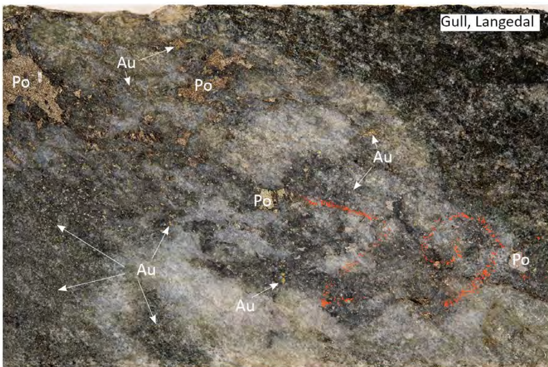
Figur 29: En ca. 10 cm tykk kvartsåre med synlig gull i omvandla noritt ble oppdaget i borekjerne LN 2007-09 ved 138,80-139,01m dybde (kjernen skjærer på skrå gjennom gullåra) i en boring som ble foretatt etter nikkell av Blackstone i 2007 på Langedal nikkell-forekomst. Gullet forekommer i en mengde korn på størrelse på opptil 1mm, og noen av dem er vist med pil (Au). I åra forekommer også magnetkis (Po) som inneholder inneslutninger av vismutminerale. Magnetkisen inneholder litt nikkell (foto: Sven Dahlgren).
