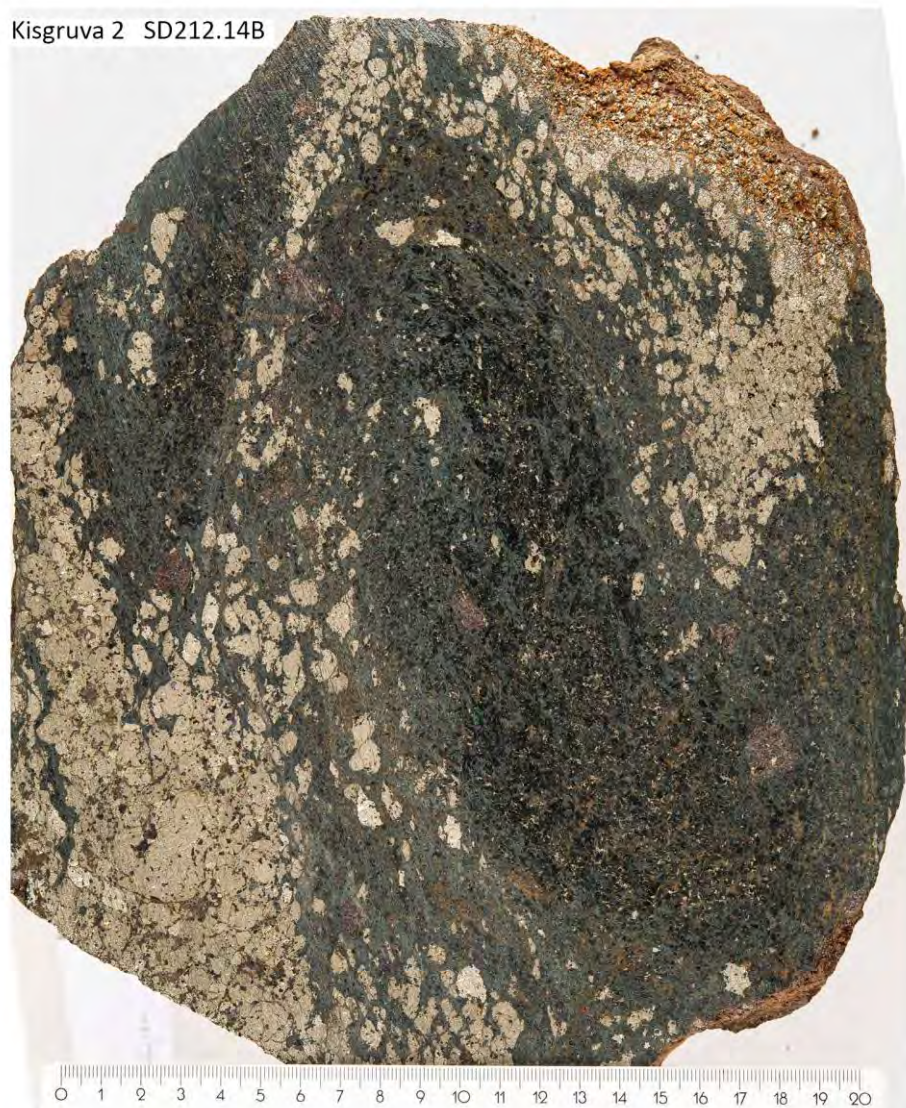
Figur 7: Kisgruva 1 (øverst): Kismineraliseringen ved Kisgruva forekommer som årer på langs og på tvers av foliasjonen i granat-amfibol-gneis. Kisgruva 2 (nederst): Mineraliseringen ved Kisgruva er foldet i tette folder sammen med granat-amfibol-gneis. (Foto: Sven Dahlgren).
