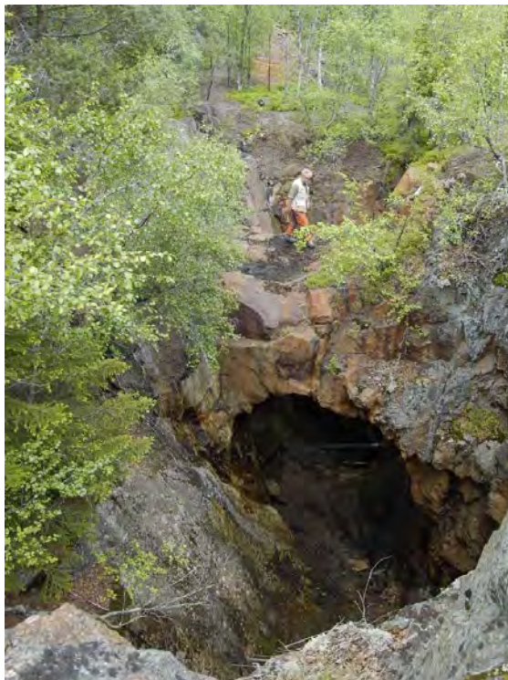
Figur 35: Dagstrossa på Grågalten sett mot nord. Over en prøve av mineraliseringen tatt i bergfestet midt i strossa bestående av finkornet pyrrhotitt-kobberkis impregnasjon (Prøve K17-6). Foto: T. Bjerkgård.
