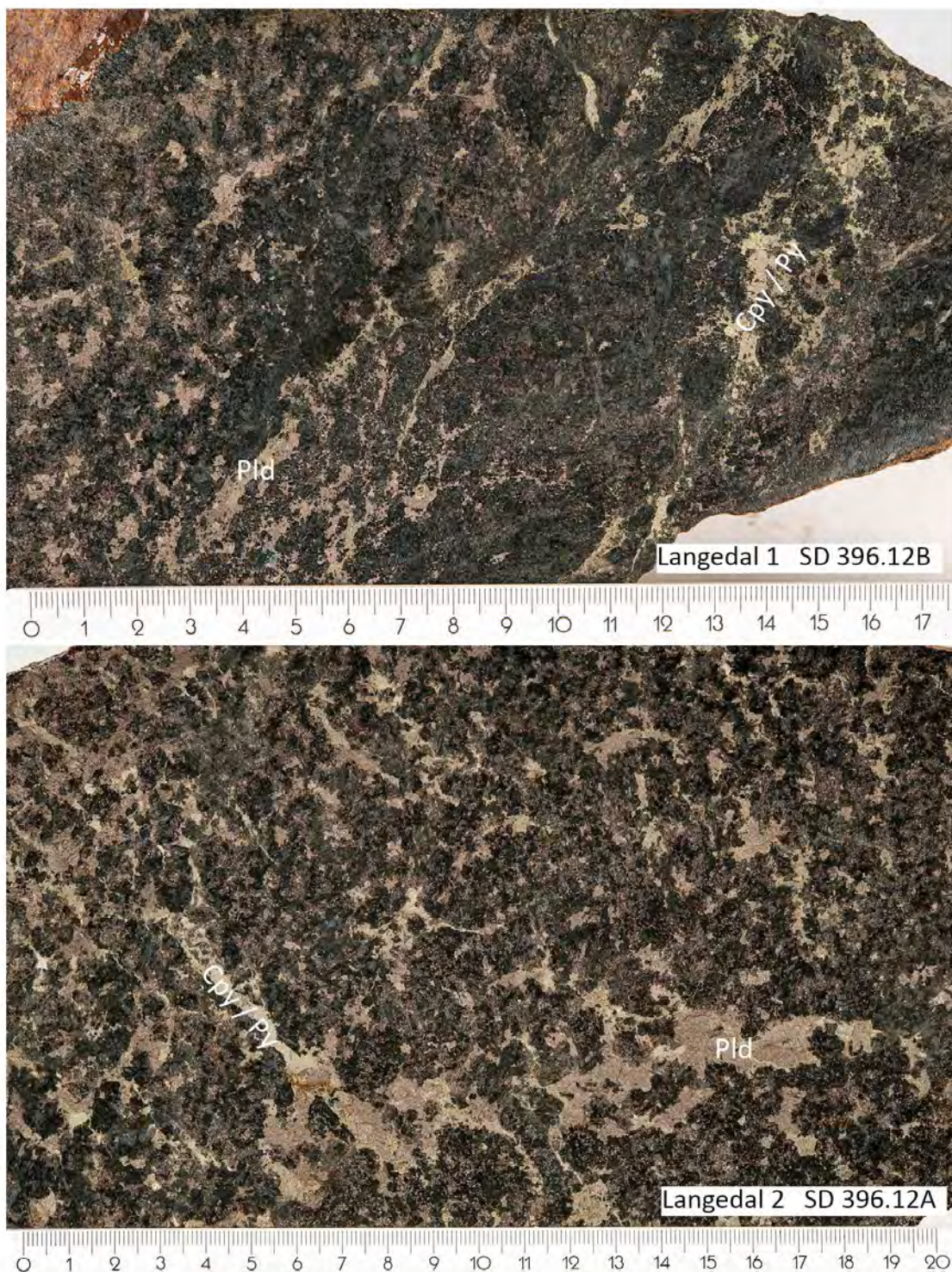
Figur 30: To teksturer fra nikkel-kobber-mineralisering i metanoritt, Langedal. Langedal 1 (øvre foto): Nikkelholdig magnetkis, pentlanditt (Pld) er disseminert i bergarten, mens kobberkis (Cpy) og pyritt (Py) har en tendens til å opptre i mindre årer. Langedal 2 (nedre foto): Typisk mineralisering med disseminert pentlanditt (Pld), og kobberkis / pyritt (Cpy/Py). Foto: Sven Dahlgren.
