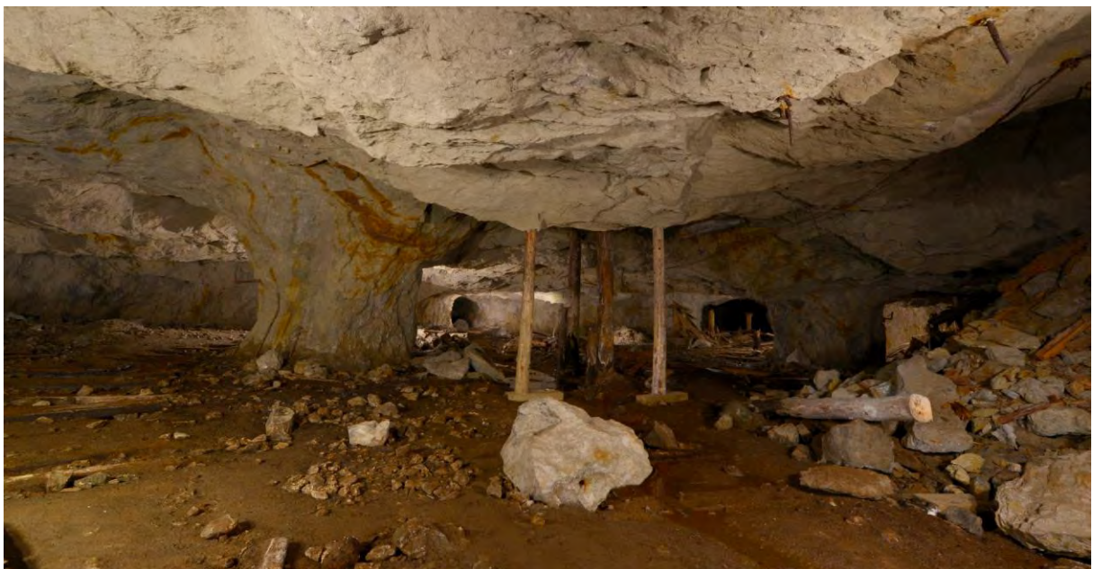
Figur 47: Granatstrossa, Kongsberg sølvgruver. Strossa har store dimensjoner. Det er 4-5 m under taket. Foto: Sven Dahlgren.
