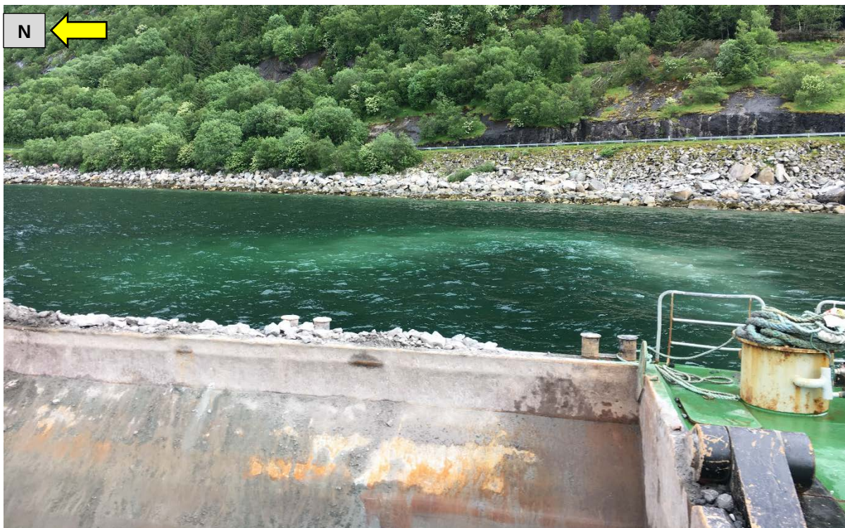
Figur 12: Partikkelspredning i overflaten mot sørvest rett etter dumping av tunneltunnler fra lekker ved «Tipp 1».
