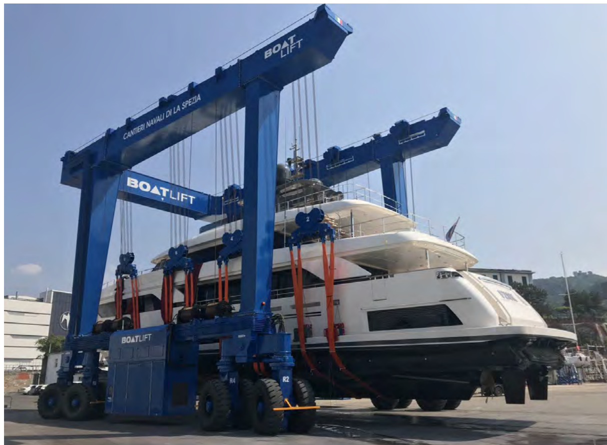
Figur 4: Eksempel på båtheis fra leverandøren Boatlift.
