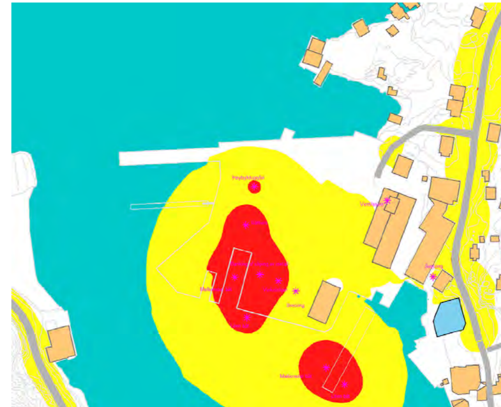
Figur 50: Støysonekart for midlertidig situasjon uten ny sliphall, nytt lager og bygninger innenfor offentlig havneområde
