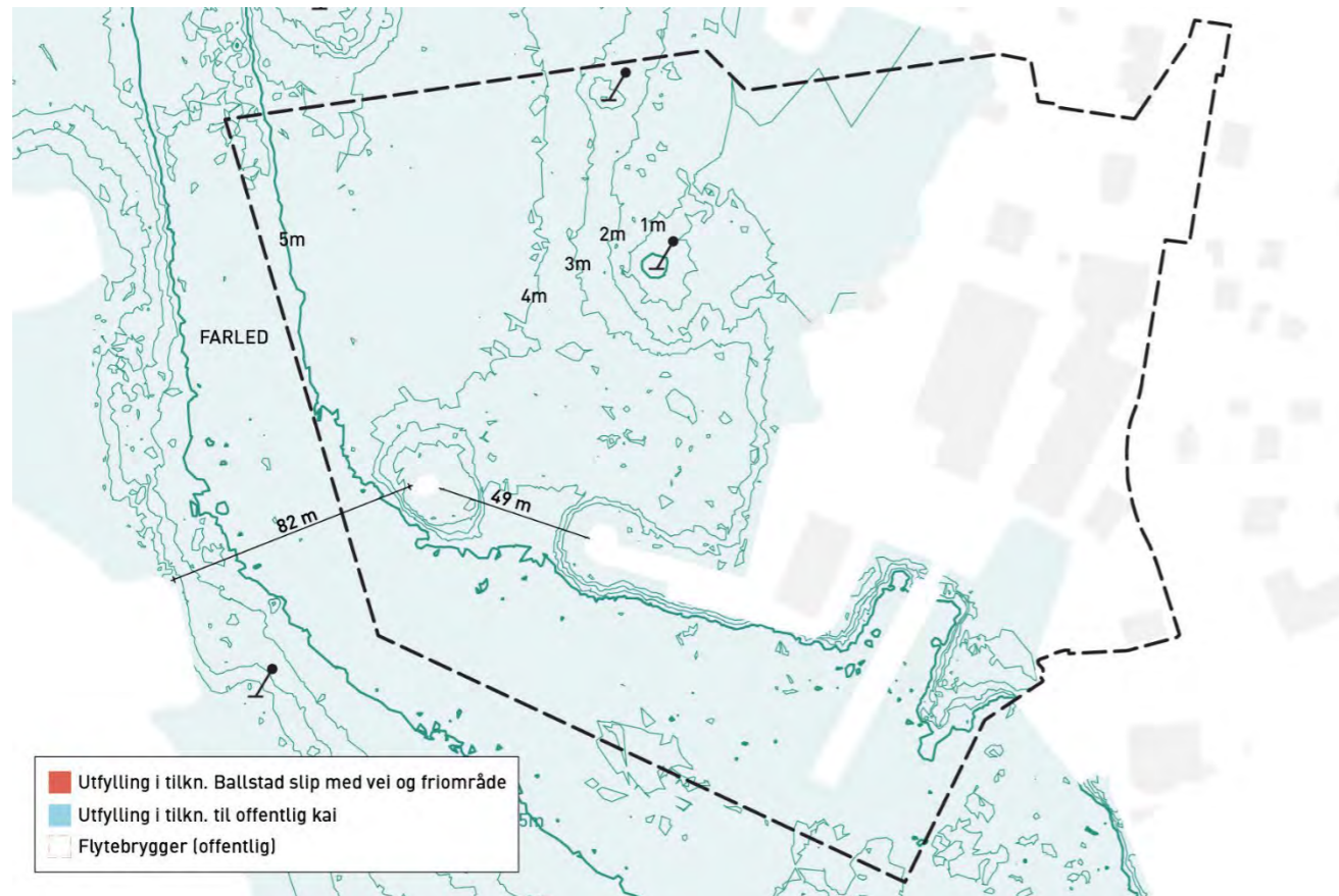
Figur 78: Kartet viser dybder i havna, eksisterende situasjon. Kartgrunnlag: Digitalt kart fra kystverket (2016), via Multiconsults rapport "Grunnundersøkelse. Orienterende geoteknisk vurdering".
