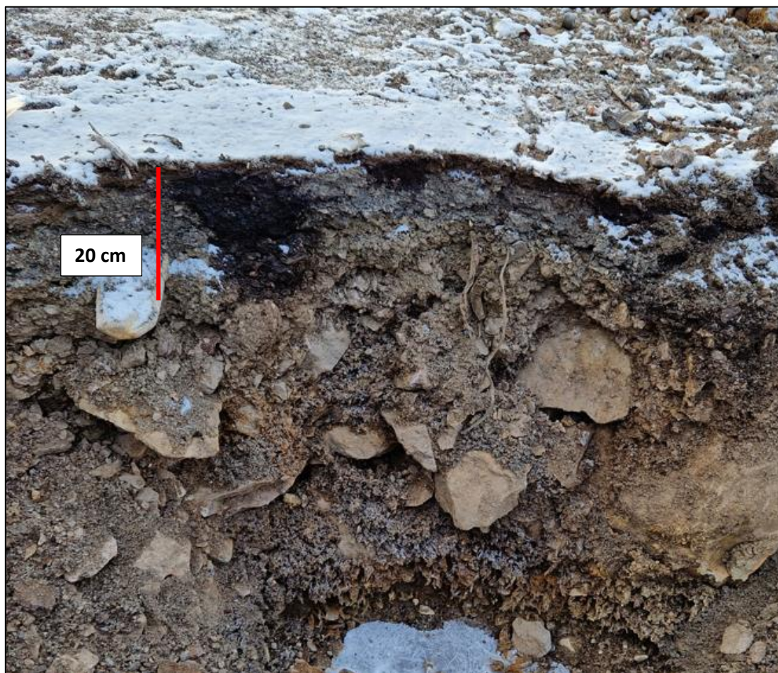
Figur 30: Jordprofil fra P14 som viser svarte masser med oljelukt i avrettingslaget i toppen. Bildet viser ikke olje i vannet, men bare oppsprukken is. Det svarte er freseasfalt og oljestoffer i avrettingsmassen.
