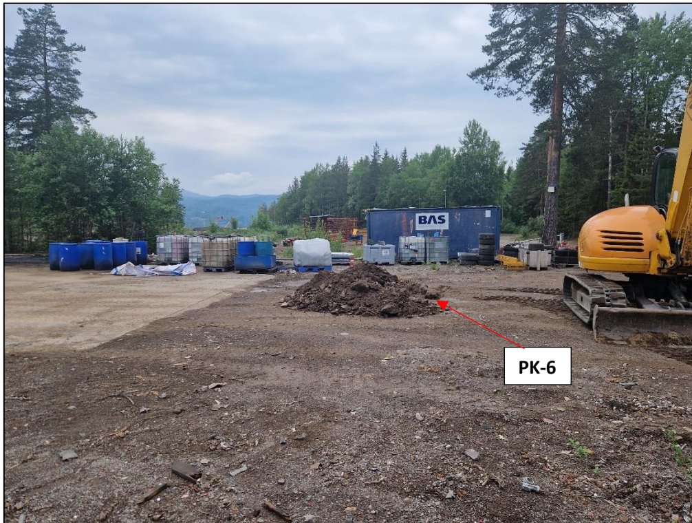
Figur 33: Prøvetaking av PK-6 på østsiden av betongplaten for å kontrollere avrenning av oljer og andre forurensninger der kjøretøy ble kjørt inn til platen for sanering.
