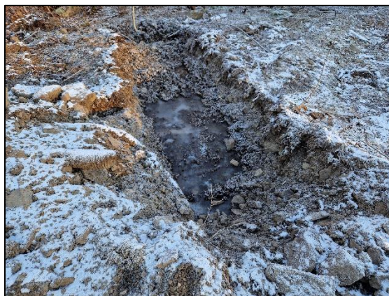
Figur 52: Betongen er makroavfall i toppmasser og ikke i selve massene. Kort vei til fjell
