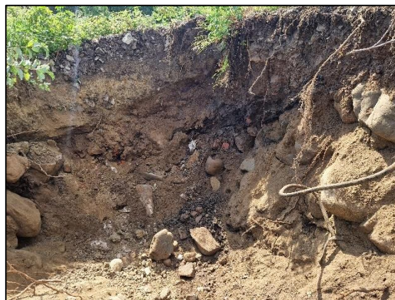
Figur 44: Eksponert lagdeling av fyllmasse mot sør (mot P40), men avfall er lokalisert i masser ved 1 m-merket
