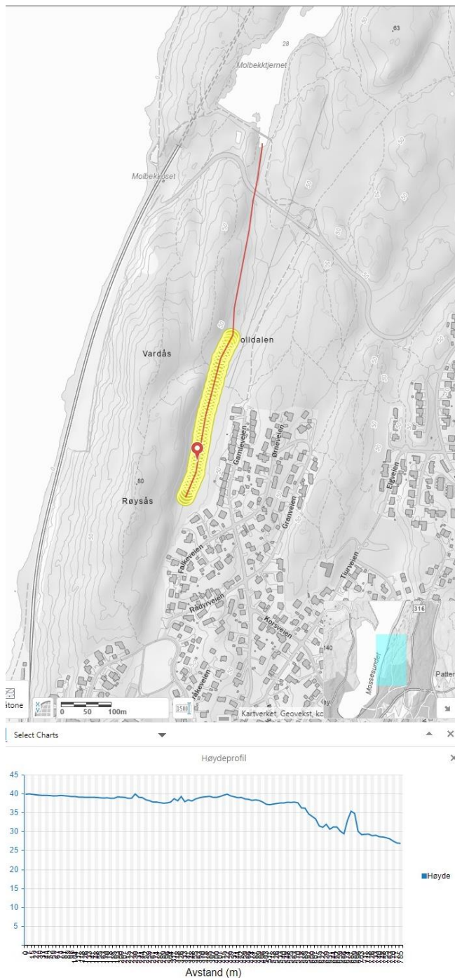
Figur 8: Terrengprofil for Molbekken, sør for Molbekktjern. Det kan se ut som det er muligheter for vandringshinder like sør for anleggsveien (representert av en lokal «topp» i terrengprofilen), men dette er ikke sjekket ut.
