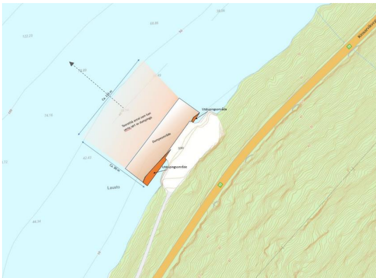
Figur 1 Oransje polygon markerer omtrentleg kvar det skal sprengjast («Utdjupingsområde»). Dumpeområde er angjeve nærast utdjupingsområdet, og teoretisk areal som kan verta rørt av dumpinga er også illustrert.
