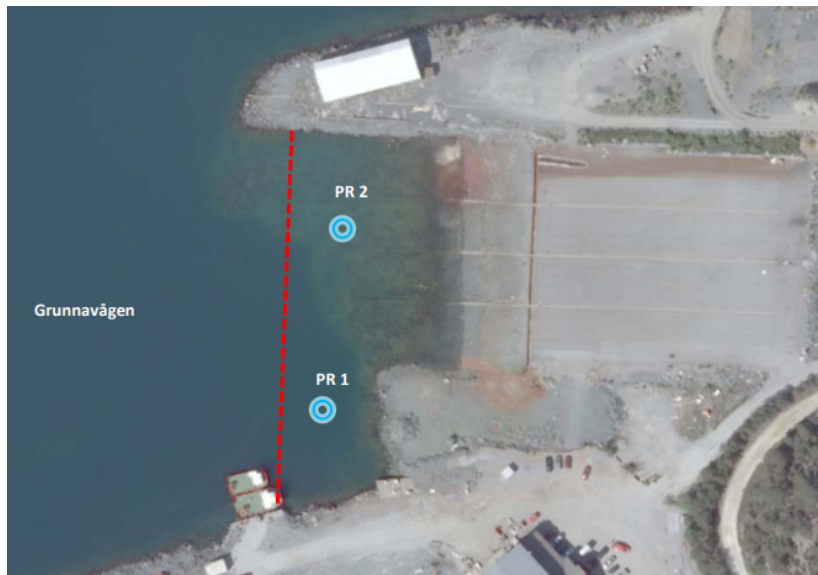
Figur 2: Raud stripla linje viser ca. avgrensing av utfyllinga, medan blå punkt illustrerer plassering til prøvestasjonar for sedimentprøver.
