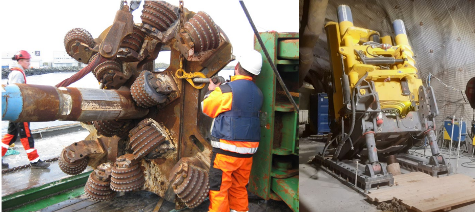
Figur 4 Døme på borkrone brukt ved opprøpping av sjakt under vatn (kilde Cowi)
