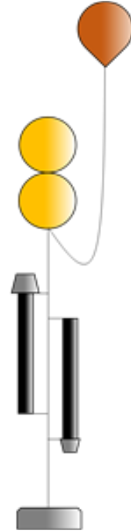
Figur 4 Prinsippskisse av strømmålerigg. AquaDopp Profiler måler oppover i vannsøylen, med ekstra punktmåler som peker nedover. Modifisert skisse fra NS 9424-1:1999. NB: I denne undersøkelsen ble det brukt en profilerende alene
